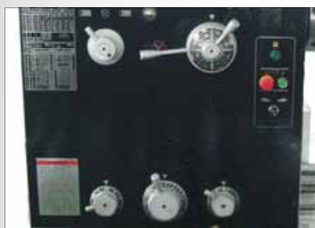
Полноразмерная коробка подач позволяет нарезать различную резьбу без замены шестерен
