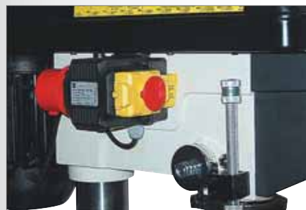
Правое и левое вращение для моделей 380 В Регулируемый упор глубины сверления
