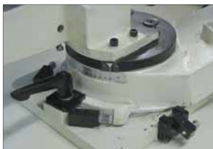
Регулируемые упоры углов положения пильной рамы MBS-712
