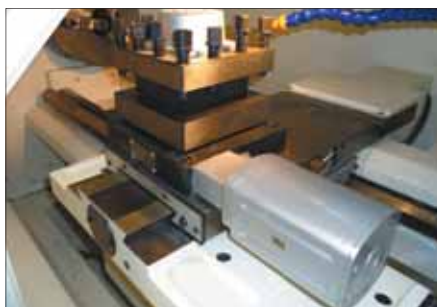
4-х позиционный резцедержатель с автоматической сменой инструмента
