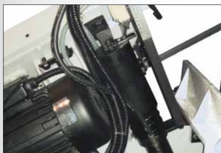
Гидроцилиндр подъема рамы с регулируемым концевым выключателем
