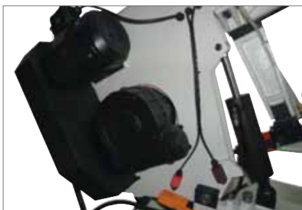
Привод и гидроцилиндр с концевыми выключателями
