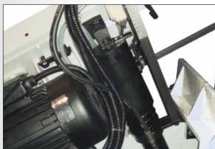
Гидроцилиндр подъема рамы с регулируемым концевым выключателем
