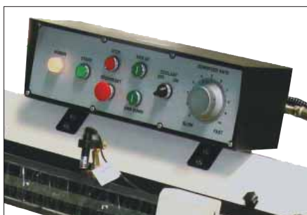
Пульт управления и световой указатель линии распила
