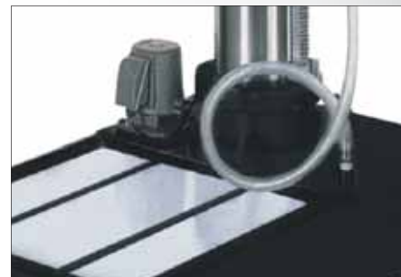
Система подвода СОЖ, встроенная в основание
