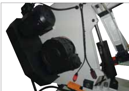
Привод и гидроцилиндр с концевыми выключателями
