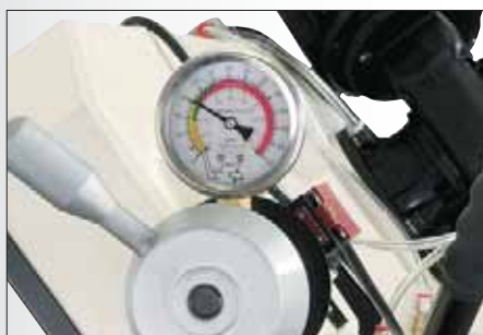
Тензометр контроля натяжения полотна
