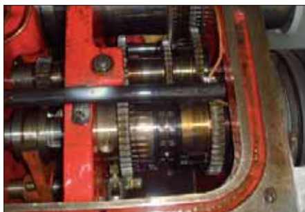
Передняя бабка с электромагнитной муфтой и централизованной системой смазки
