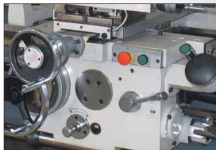
Управление продольной и поперечной подачей джойстиком с кнопкой ускоренного перемещения
