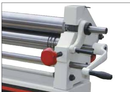
Приводная рукоятка и замок извлечения трубы
