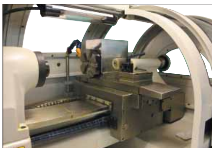
6-позиционная револьверная голова и однопозиционный резцедержатель
