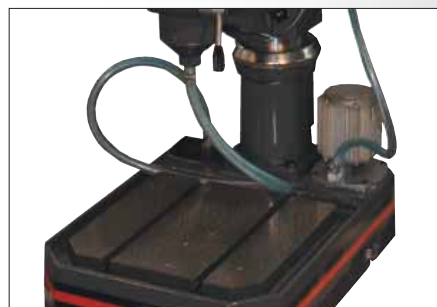
Подставка со встроенной системой подвода СОЖ
