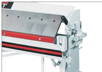
Эксцентриковая рукоятка и механизм регулирования зазора BP-1650N
