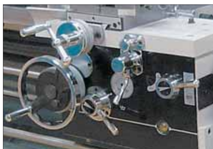
Централизованная система смазки продольного суппорта, рукоятки управления суппортом
