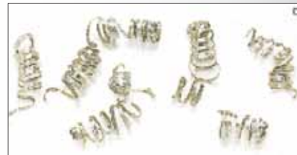
Свободно намотанная (витая) стружка – идеальные условия резания
