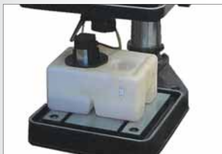
Бак и насос системы подвода СОЖ (GHD-27, GHD-27PF)
