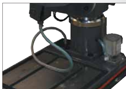
Система подвода СОЖ, встроенная в основание
