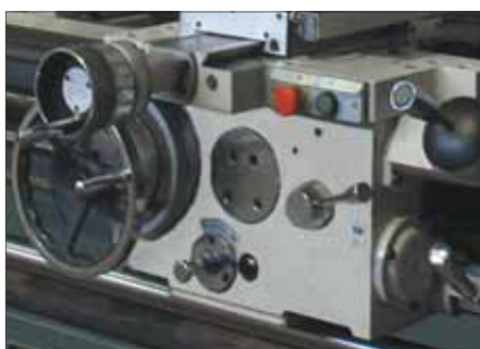
Управление продольной и поперечной подачей джойстиком с кнопкой ускоренного перемещения
