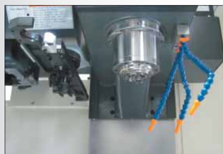
Шпиндель с системой подвода СОЖ и устройством автоматической смены инструмента
