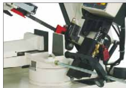
Поворотная консоль и гидроцилиндр
