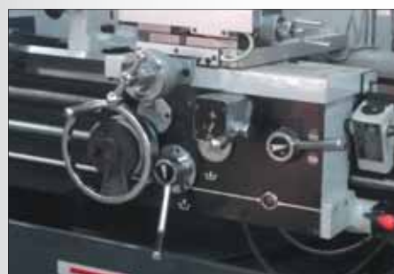
Суппорт с указателем для нарезания резьбы
