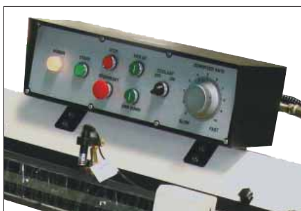
Пульт управления и световой указатель линии распила
