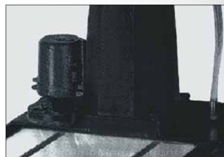
Система подвода СОЖ, встроенная в основание
