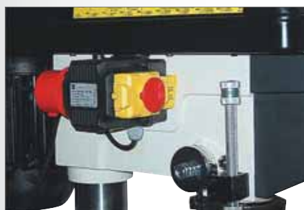
Правое и левое вращение для моделей 380 В Регулируемый упор глубины сверления (JDP-17F)
